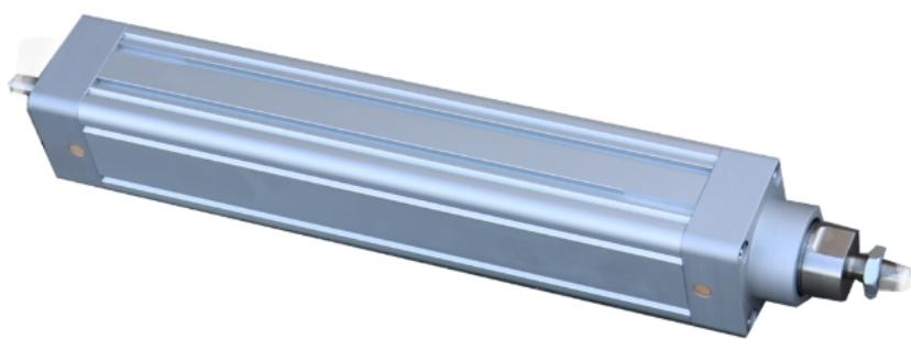
作为机械行业从业者，电缸相信大家都不陌生。它可以简化设计者工作量，在有限的空间里实现更多的功能，同时美观、可靠性强。电缸的构成、分类齿形带式电缸。这是\*\*常见的一种电缸，电缸通常由自支撑结构型材、直线导轨、齿形带、齿形带轮、防尘带、滑架、及若干其他附件组成。精度适中、行程可选范围广，使用范围很\*\*\*。滚珠丝杠式电缸。这种电缸由自支撑结构型材、直线导轨、滚珠丝杠、防尘带、滑架、及其他若干附件组成。区别于齿形带传动，滚珠丝杠传动精度更高，安装精度、成本各方面也更高。通常应用在精度要求很高的场合。齿轮齿条式电缸。这种电缸驱动方式为齿轮齿条，可以提供更大的驱动力，适用于重载场合，一般来讲，规格型号都比较大。电缸的驱动方式与性能息息相关，但如何找到\*\*合适的驱动系统，为了说明，
